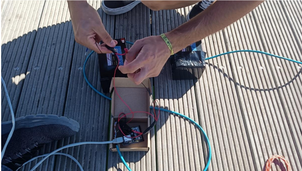
FIGURA 11 – BATERIAS DE ALIMENTAÇÃO E PLC DE COMUNICAÇÃO COM O MÓDULO DA CÂMARA DURANTE O TESTE.
