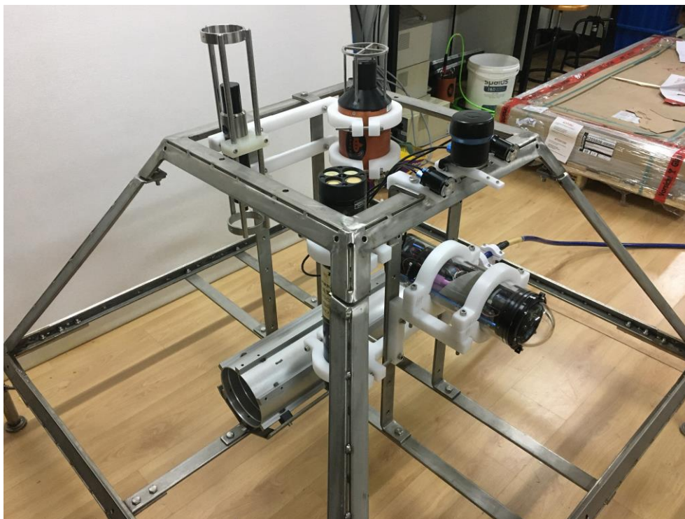
FIGURA 3 – FOTO DA ESTRUTURA DA ESTAÇÃO SUBAQUÁTICA COM OS VÁRIOS EQUIPAMENTOS.
