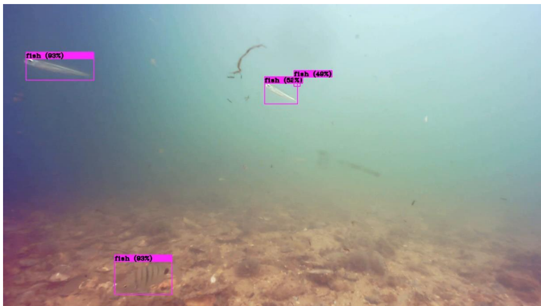
FIGURA 14 – EXEMPLO DO MODELO DE DETEÇÃO PREVIAMENTE TREINADO A AVALIAR OS VÍDEOS DO TESTE.
